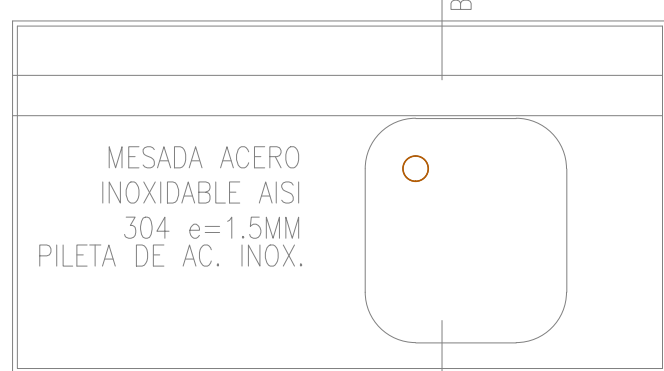
DETALLE DESAGÜE DE PILETA SIMPLE PLANTA
